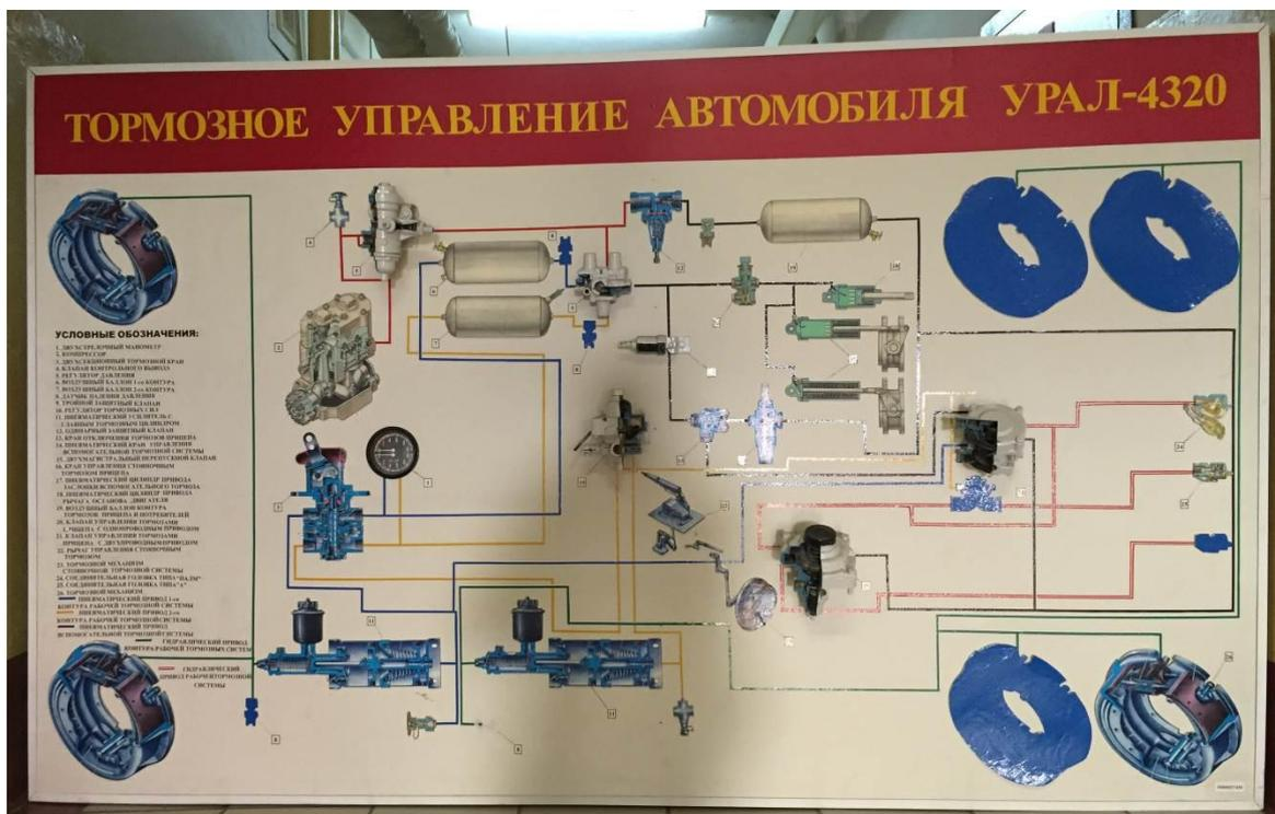
Рис. 3. Демонстрационный стенд тормозного управления автомобиля Урал-4320-31
